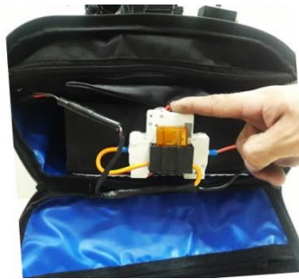
Passo 1 - Desligue a Chave disjuntora de segurança.
