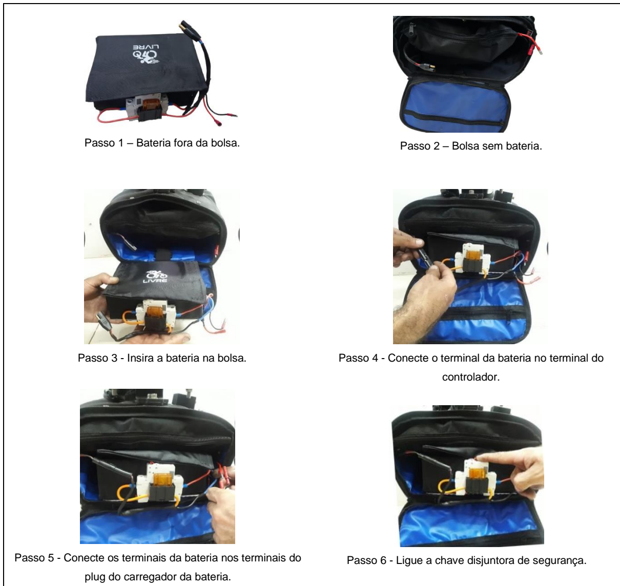
Figura 22 - Sequência para acoplamento da bateria.
