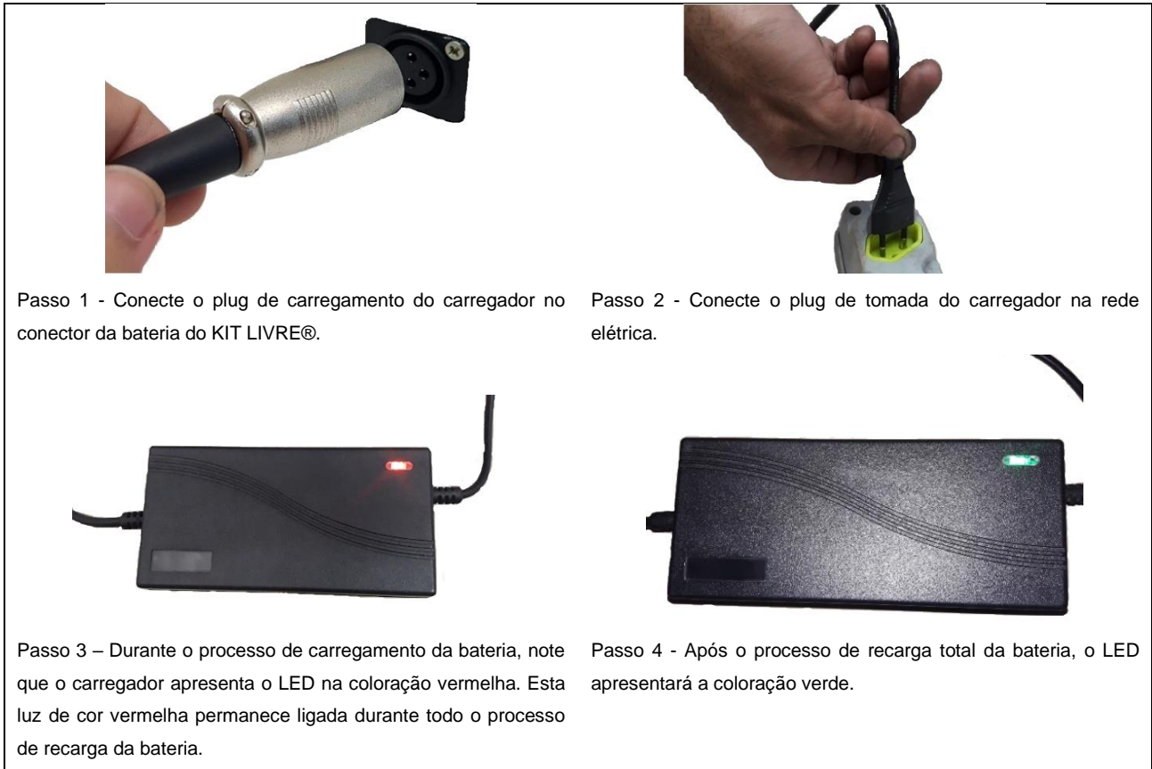
Figura 25 – Processo de recarga da bateria do KIT LIVRE®.
