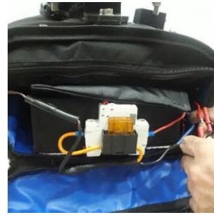
Passo 2 - Desconecte os terminais de conexão da bateria do plug do carregador da bateria.
