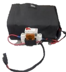
Figura 18 – Bateria LiFePO 4 48V 12Ah.
