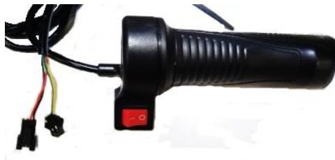
Figura 26 - Acelerador de Punho.
